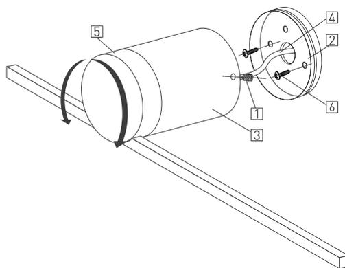
Рис. 2. Установка и подключение светильника
